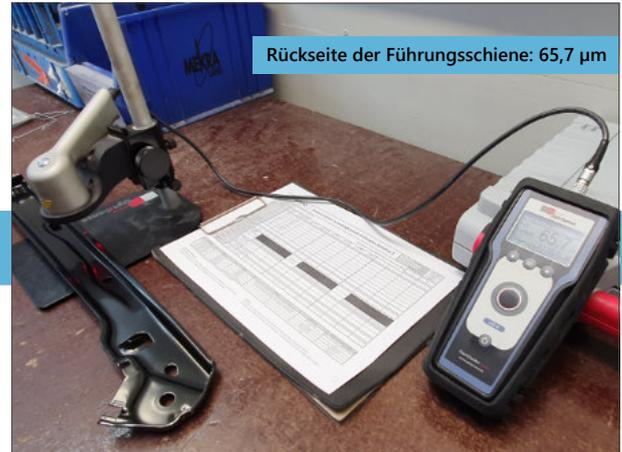
„Wenn sich dann erst herausgestellt hat, dass die Schichtstärke nicht stimmt, war die gesamte Strecke nach der Applikation Verlust. Denn die Parameter, die in der Anlage eingestellt sind, gelten für die gesamte Charge. Eine große Menge wäre fehlbeschichtet und müsste kostenintensiv entsorgt werden“, rechnet Jobst vor.
