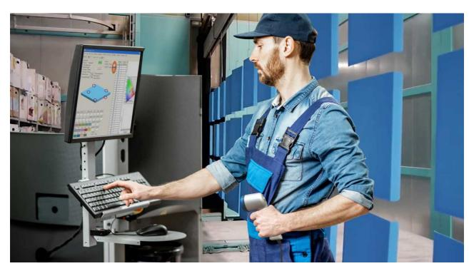
Möglichst früh im Verfahren Schichtdeckenmessung vornehmen, lautet die Devise bei GSO – hier Kontrolle vor dem Einbrennen.
