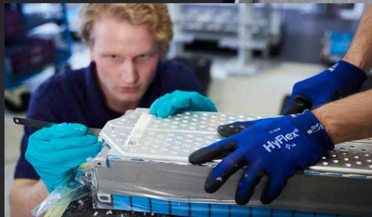
Das Aluminiumgehäuse der Batteriezelle erhält eine Beschichtung, die sowohl die Oberfläche schützt als auch die Isolationsfunktion übernimmt
