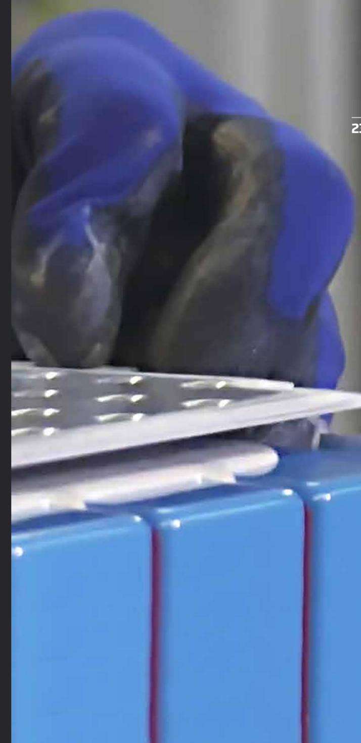
Aufbau einer Autobatteriezelle. Die Zellen müssen voneinander isoliert werden, um einen Kurzschluss zu verhindern.
