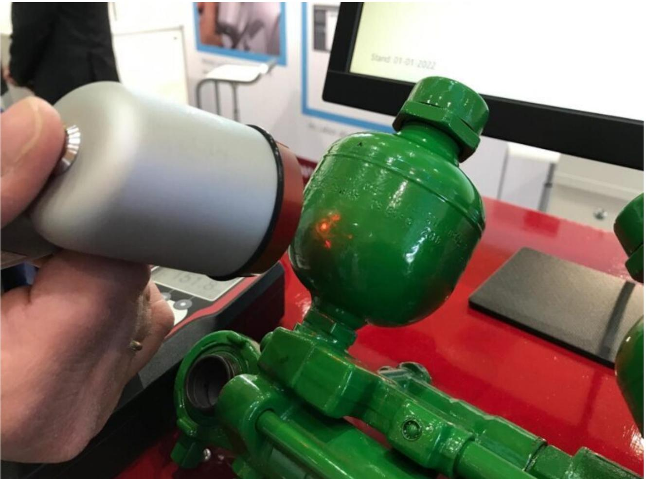
Mit den „PaintChecker“-Prüfsystemen stellen Anwender schon früh im Prozess fest, ob die Schichtdicke exakt aufgetragen wurde. Foto: Redaktion
