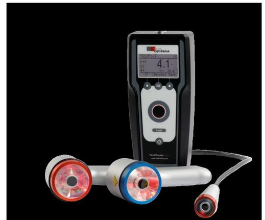
Das komplette Messsystem besteht aus zwei Einheiten: Dem Controller mit der Auswerte-Elektronik und dem leichten, kompakten Sensor als eigentlichem Messgerät (Bild: OptiSense)
